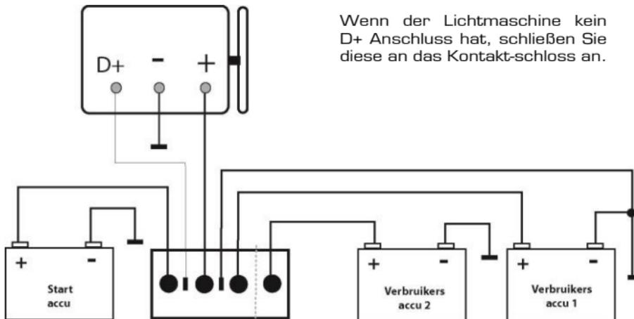
Wenn der Lichtmaschine kein D+ Anschluss hat, schließen Sie diese an das Kontakt-schloss an.
